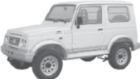
SJ413 TECHO METALICO
